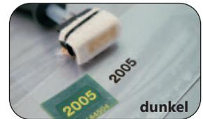
Durch Auftragen des korrosionsfreien Elektrolyts auf die Siebdruckschablonen können Firmenlogos, Seriennummern usw. auf Metallflächen wie z.B. bei Typenschildern und Werkzeugen dauerhaft signiert werden.
