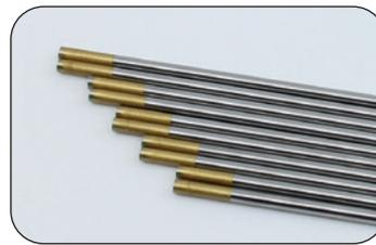
Dieser Typ besteht aus 98.5 % Wolfram und 1.5 % Lanthanoxid und ist absolut strahlungsfrei. Geeignet für Gleich- und Wechselstrom-schweißungen, einsetzbar für alle Anwendungen. Der Schweißstrom beim Wechselstromschweißen sollte ca. 250 A nicht überschreiten.
