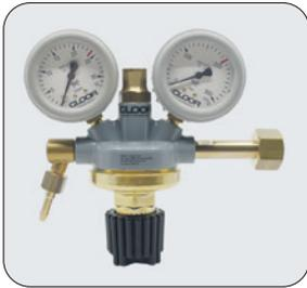
Druckreduzierventil mit zwei Manometeruhren für das Schutzgasschweissen mit Argon, Argonmischgase sowie CO<sub>2</sub>. Arbeitsmanometer 24 l/min.
