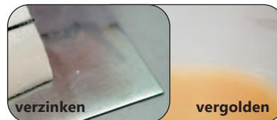
Beim galvanischen Beschichten können Korrosionsschutzschichten wie z.B. Zinn und Zink aufgebracht werden. Zum Veredeln von Metalloberflächen können Gold, Silber oder Nickelschichten aufgebracht werden.
