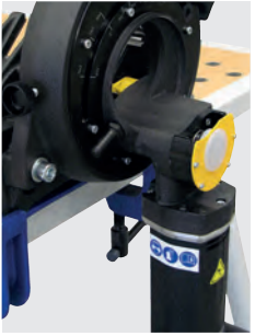
Inklusive zweite Sägeblattaufnahme zum Heraustrennen von Rohrbögen
