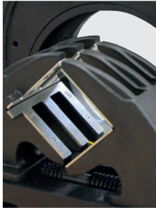
Inklusive Stahlgleitspannbacken mit Edelstahlspannaufsätzen
