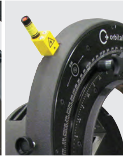
Integrierter Strichlaser zur Trennstellen-Markierung auf dem Rohr
